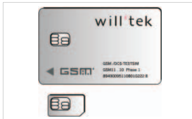
Carta SIM in formato carta di credito (ISO) (sopra) ed in formato plug-in.
